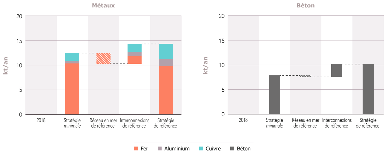
Figure 13.12 Consommation de matières (à gauche métaux, à droite béton) associées à la mise en œuvre des raccordements en mer et des interconnexions (PPE, moyenne annuelle sur la période d'étude)
