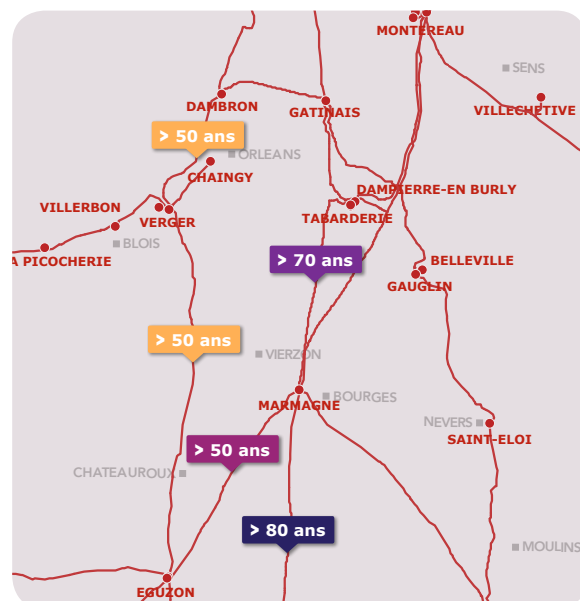
Figure 7.8 Âge des conducteurs des axes à 400 kV nord-sud de la région (au 1 er janvier 2020)
